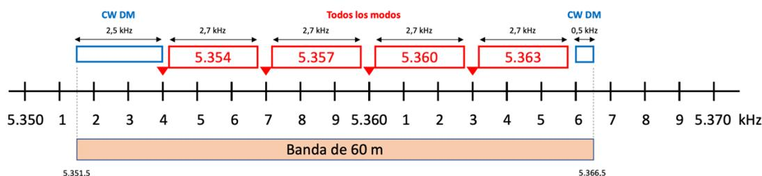
**Figura 1 - Canalización sugerida para la banda de 60 m**
