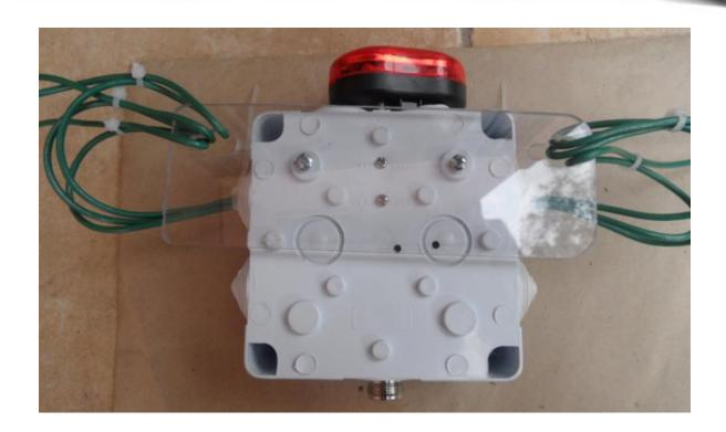
Así es como debe quedar el acrílico de 3 milímetros tras la caja. Aquí se puede apreciar el uso de amarras plásticas para dar sujeción a los dipolos y no ejercer presión en la placa que se encuentra en el interior de la caja de derivación.
