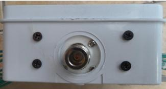
En las imágenes se puede apreciar la placa con sus dipolos y cables de conexión al conector tipo N hembra de chasis, el cual está perfectamente en el lugar seleccionado para que quede firmemente a la caja.
