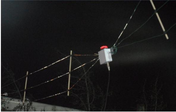
En las imágenes anteriores podemos apreciar la antena bigote de gato completamente instalada y operativa.
