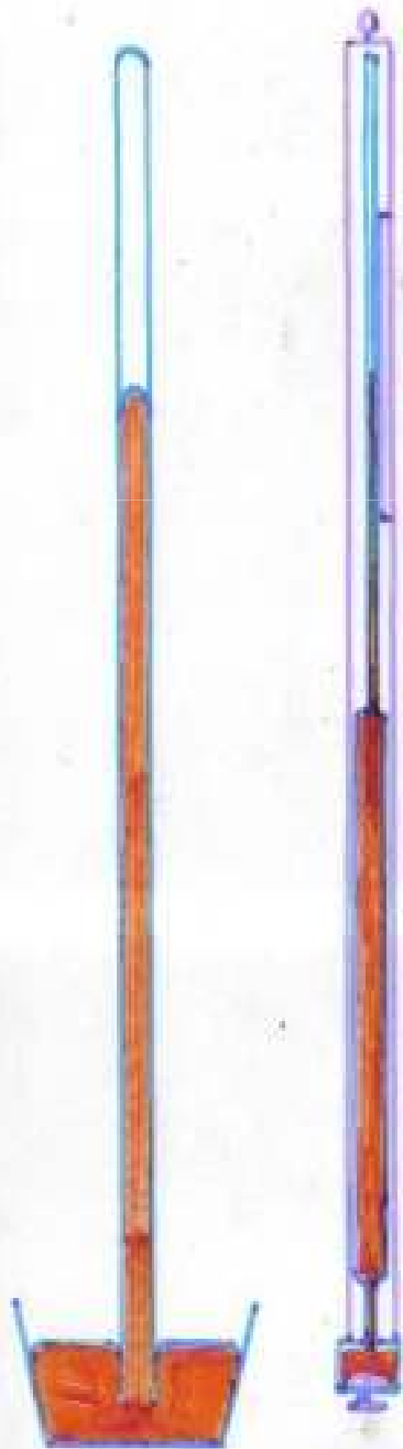
BAROMETRO MERCURIAL BASADO EN EL EXPERIMENTO DE TORRICELLI
