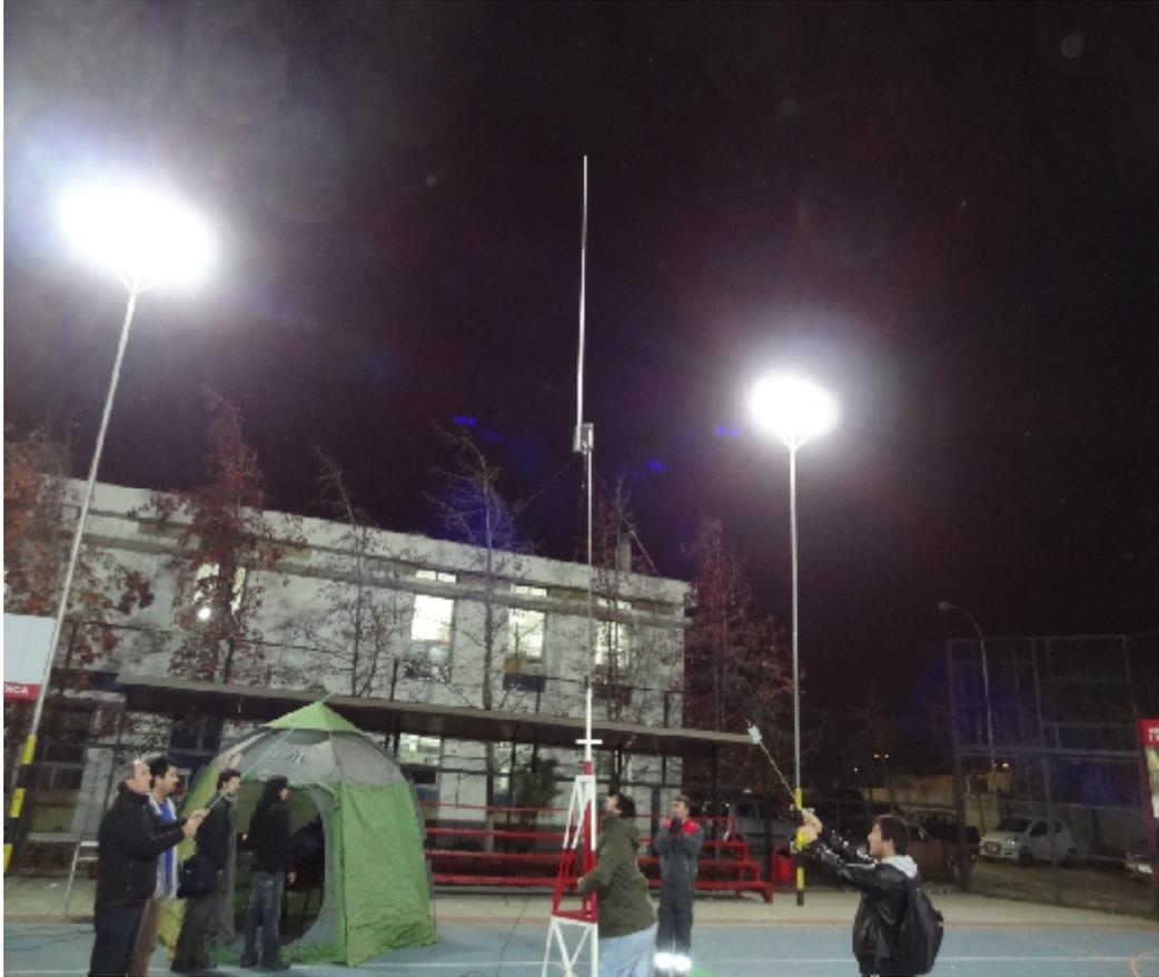
En este punto se monta la antena al mástil para probar su funcionamiento, el irradiante fue ajustado a 2,75 metros de largo.
