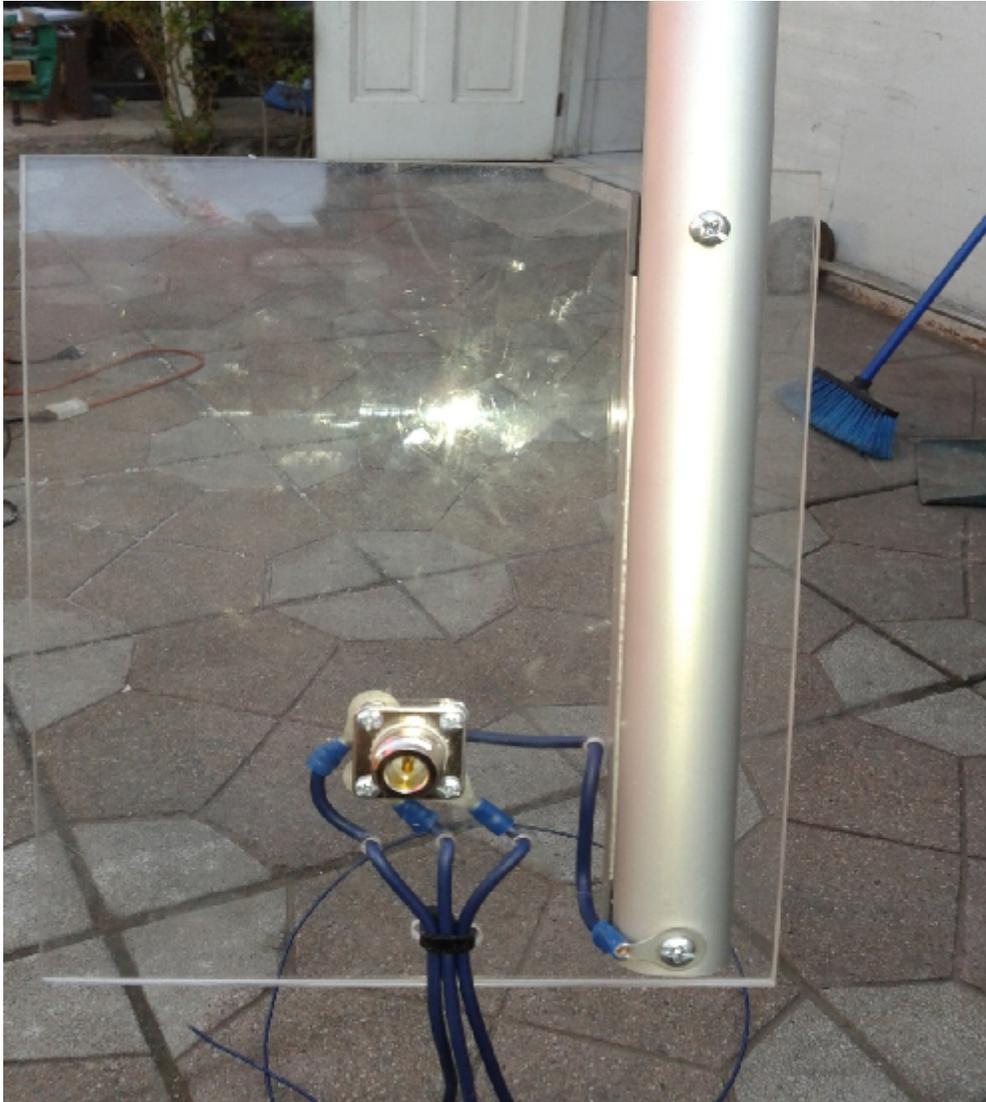
En este punto se debe fijar el conector N hembra chasis al acrílico mediante pernos, los planos de tierra deben ir conectados a la masa del conector y fijados con un precinto plástico, un cable pequeño debe ir soldado con estaño al pin trasero del conector N hembra, el otro extremo debe ir conectado al irradiante como se muestra en la imagen.
