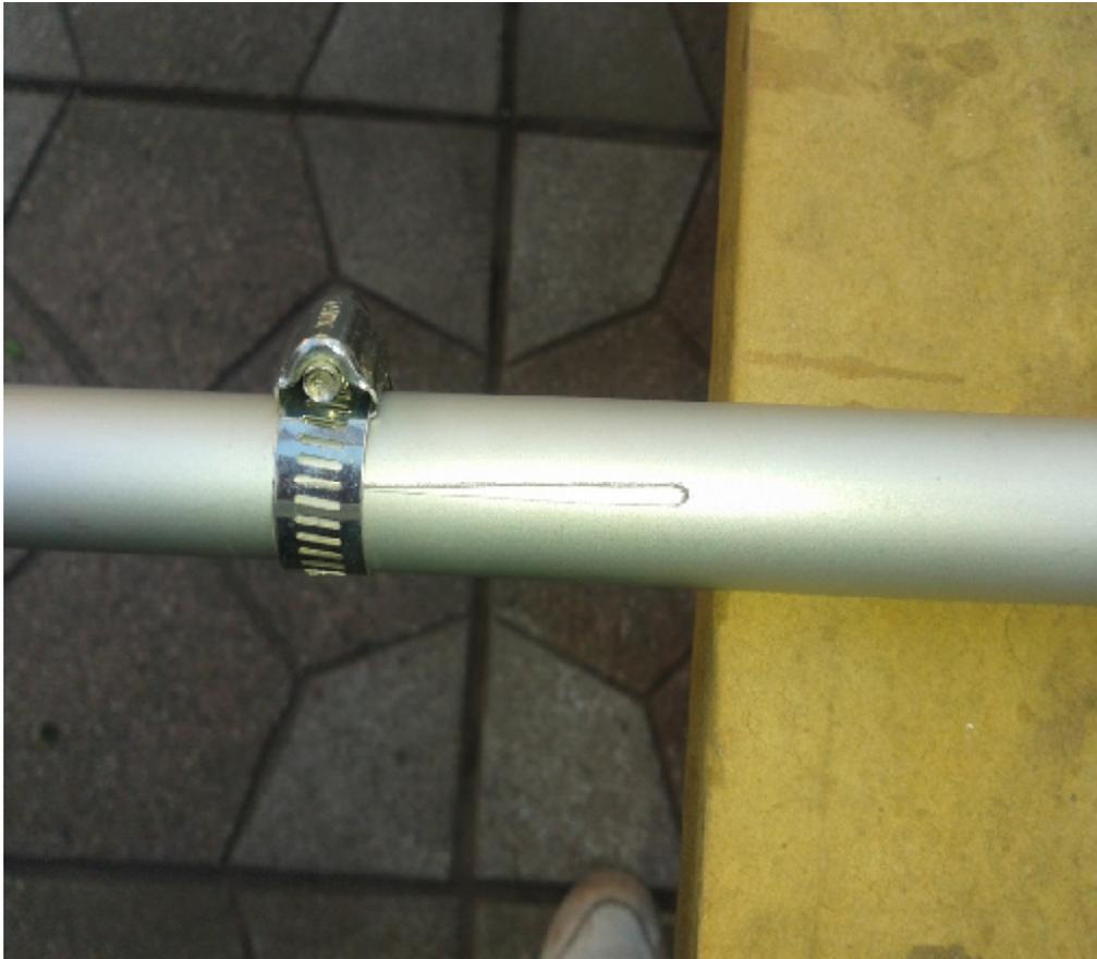
Realizar dos cortes en paralelo con la galleta de corte para montar en tubo sobre otro este proceso se debe realizar en los dos tubos más anchos, para dar firmeza se utilizan las abrazaderas ajustables como se muestra en la imagen.
